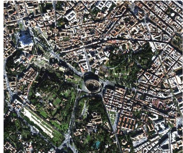
QuickBird acquisisce contemporaneamente immagini pancromatiche, con una risoluzione spaziale di 61 centimetri, e immagini multispettrali in 4 differenti bande, dal visibile all'infrarosso vicino, con una risoluzione spaziale di 2,44 metri.
