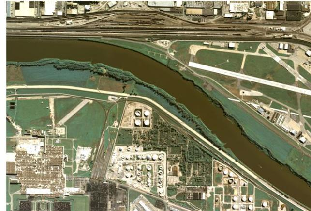
GeoEye-1 è dotato inoltre di una notevole agilità che gli consente di acquisire aree piuttosto ampie anche in modalità stereoscopica: in questo modo si ottengono coppie di immagini con condizioni simili di acquisizione, particolarmente valide per l'estrazione di Modelli Digitali del Terreno (DEM).
